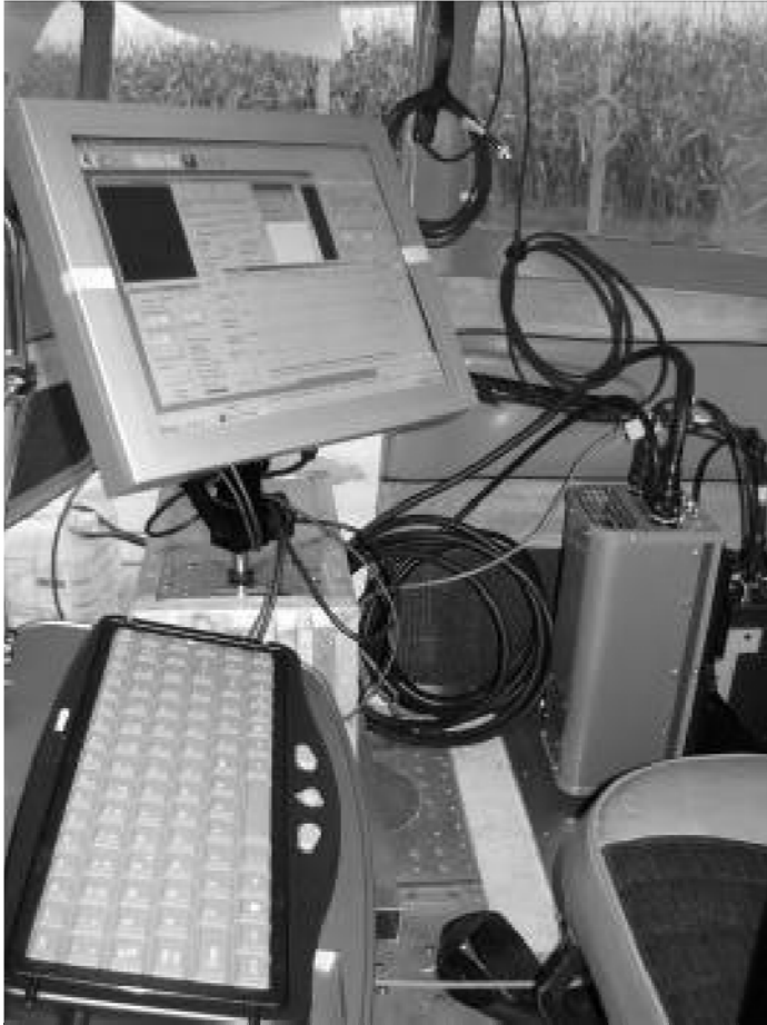
3.ábra AISA Eagle II hiperspektrális szenzor és fedélzeti rendszer repülőgépbe beszerelve
